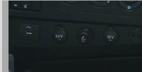
Nuevas conexiones Tip-A USB & Tip-C
